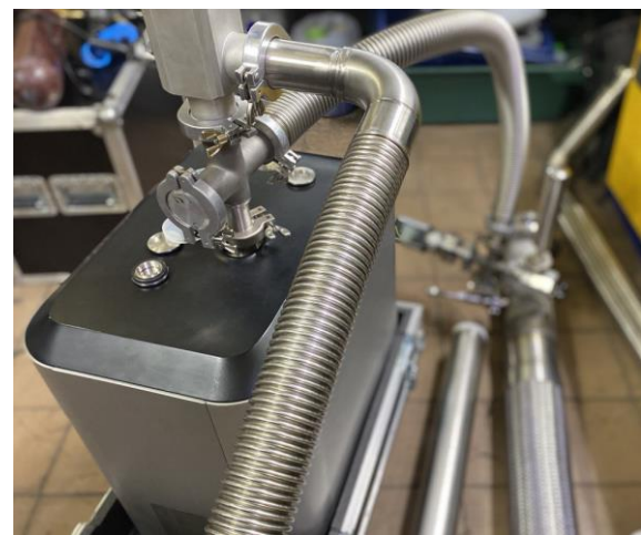
Процесс контроля герметичности сильфонов с угловым присоединением на гелиевом течеискателе
